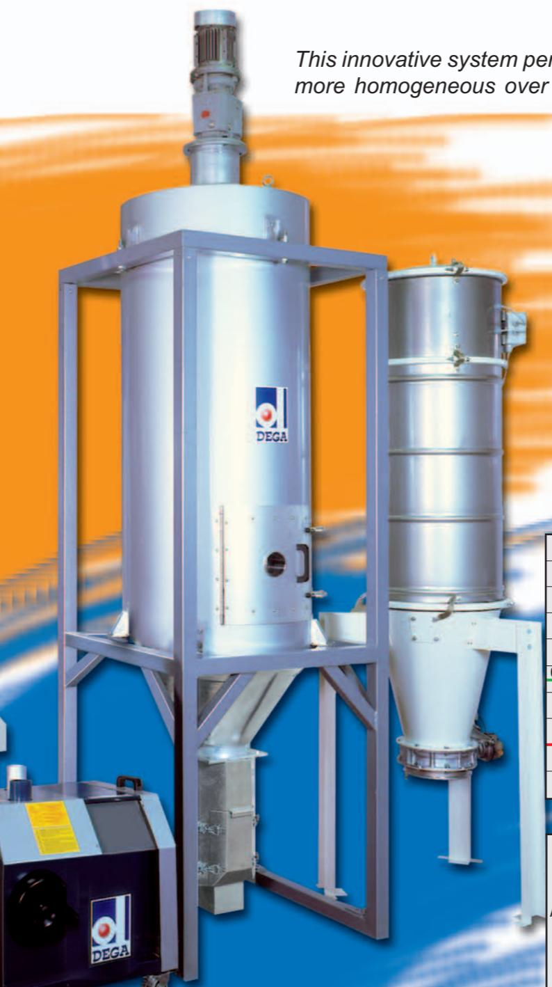
La serie ACP Automatic Process controllato da un processore con schermo Touch Screen, controlla e gestisce automaticamente il processo di cristallizzazione comparando la temperatura raggiunta dal materiale con lo sforzo in ampere del motore degli aspi rompiconte, evitando l'agglomerarsi dei flakes quando si raggiunge il punto Vicat. Il ciclo di cristallizzazione è sempre sotto controllo, e non necessita di alcun presidio da parte degli operatori anche con il ciclo a Bact.
