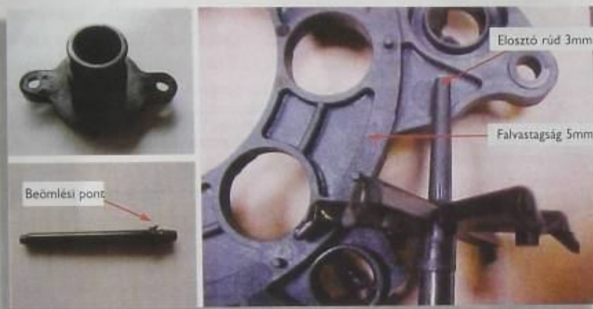
Értes és hullámos felület keletkezik, ha a formadarab keresztmetszete nagyobb, mint a beömlő (balra: rögzítő hüvely engusszal, jobbra: technikai formadarab elosztóval)
