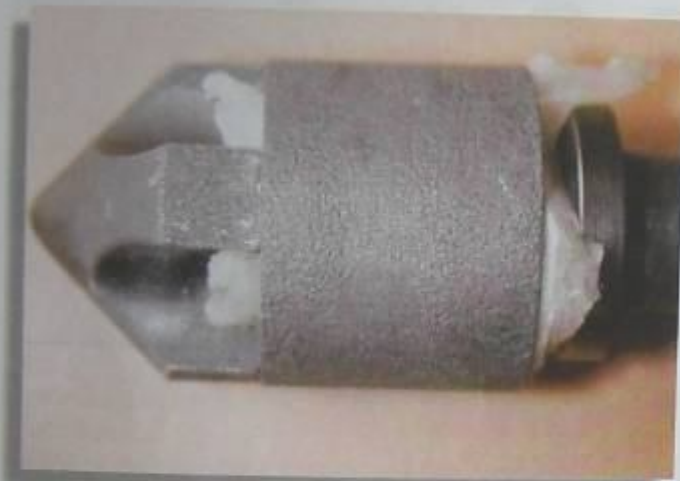
Erős korrózió egy visszadramlásgátlóval rendelkező csigacsúcsan, ami egy égésgátolt tartalmazó alapanyag szakszerűtlen feldolgozásának a következménye (túl rövid előszárítás, túl magas hőmérséklet)
