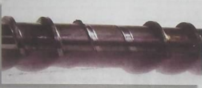
Példa az abrazív kopásra: 1500 üzemóra elteltével 50 % üvegszállal töltött poliamid feldolgozása esetén.
