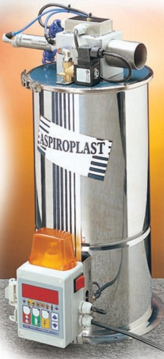
Ciclone per la raccolta del granulo sulla tramoggia. Scelto fra le 3 grandezze per adeguarsi alle dimensioni dell'impianto e alle condizioni di installazione.
