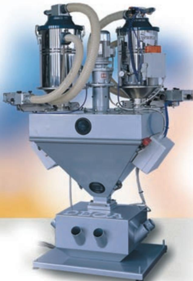
IL software di controllo e gestione dell'impianto di trasporto, è interfacciato con il software dell'impianto gravimetrico. Ad ogni richiesta di materiale il gravimetrico produce la ricetta e la distribuisce ai contenitori di stoccaggio o direttamente alla macchina che ne ha fatto richiesta.
