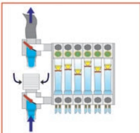
Impianto con sistema centralizzato di svuotamento acqua stampi
